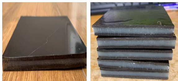
รูปที่ 2 วัสดุแซนด์วิชที่มีแผ่นประกบจากวัสดุเชิงประกอบพลาสติกและไม้ และแกนกลางจากพลาสติก
