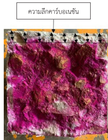
รูปที่ 3 การวัดความลึกคาร์บอนเนชั่นของตัวอย่างคอนกรีต
