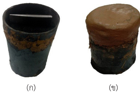
รูปที่ 4 (ก) บรรจุชิ้นทดสอบมิดลงในกล่องพร้อมสารเพิ่มคาร์บอน (ข) การปิดทับปากกล่อง
