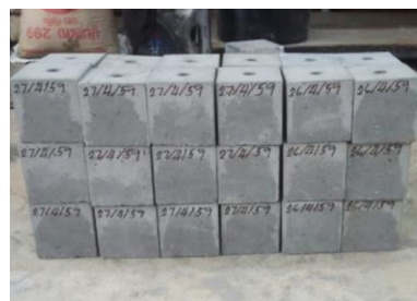
(ข) เจาะรูคอนกรีตให้มีขนาด เท่ากับ 22 มิลลิเมตร
