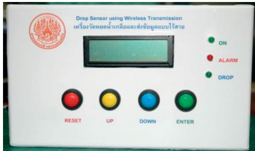
รูปที่ 4 ชุดภาควัดหยดน้ำเกลือและส่งข้อมูลแบบไร้สาย
