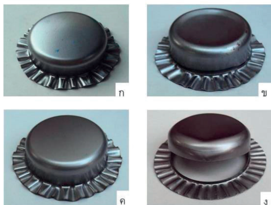
รูปที่ 13 ชิ้นงานหลังการขึ้นรูป ก) การขึ้นรูปแบบปกติ ข) การขึ้นรูปที่แรงดัน 50 ค) 100 และ ง) 150 บาร์
