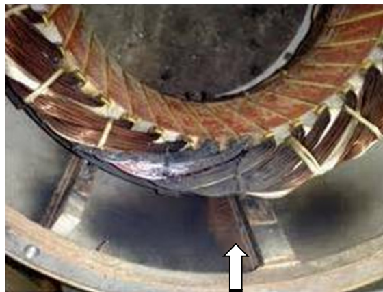
รูปที่ 1 รูปจริงของตัวนำสเตเตอร์ลัดวงจร ( http://arcsy-stems.businessstobusinessblog.ws )
