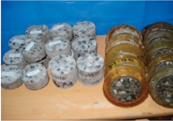
ก) เครื่องตัวอย่างทดสอบด้วยอีพอกซี
