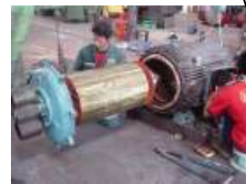
รูปที่ 1 ตัวอย่างความล้มเหลวของตัวนำสเตเตอร์และแท่งตัวนำโรเตอร์ของมอเตอร์ที่มักจะเกิดขึ้นในกระบวนการผลิตของภาคอุตสาหกรรม
