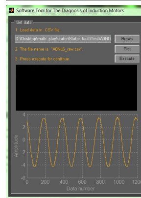
รูปที่ 10 การแสดงผลการดำเนินการของหน้า GUI ที่ได้ออกแบบขึ้นพร้อมทั้งการแสดงผลสัญญาณกระแสเตเตอร์ของมอเตอร์เหนี่ยวนำที่นำมาทำการทดสอบ
