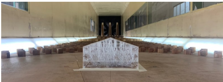
รูปที่ 2 อุโมงค์ลม ธรรมชาติ-เอไอที และแบบจำลองอาคารเดี่ยว
