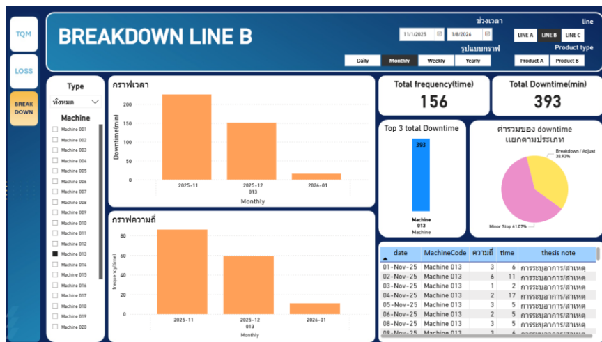
รูปที่ 14 หน้าปัดแสดงผลการวิเคราะห์การหยุดชะงักของเครื่องจักร
