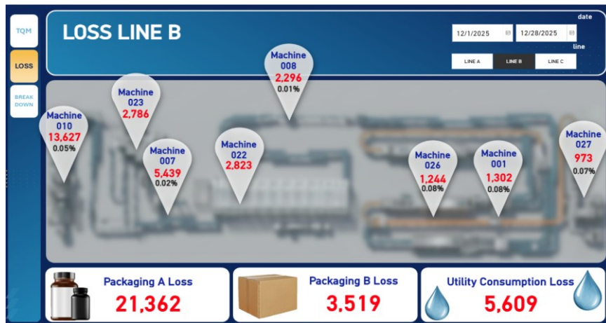
รูปที่ 13 หน้าปัดแสดงผลการวิเคราะห์ความสูญเสียในกระบวนการ
