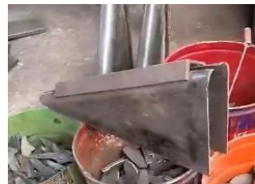
3) ใช้ Fixture lay out เพื่อตัดส่วนเกิน
