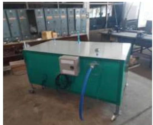
รูปที่ 1 เครื่องผลิตฟองอากาศด้วยกลไกการทำความร้อน
