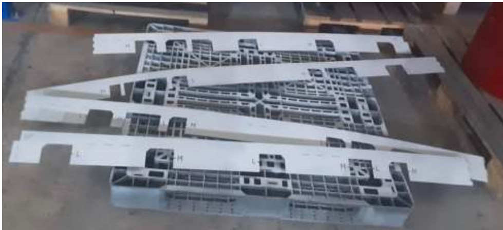
รูปที่ 5 จิ๊กเทมเพลตที่ออกแบบขึ้น
