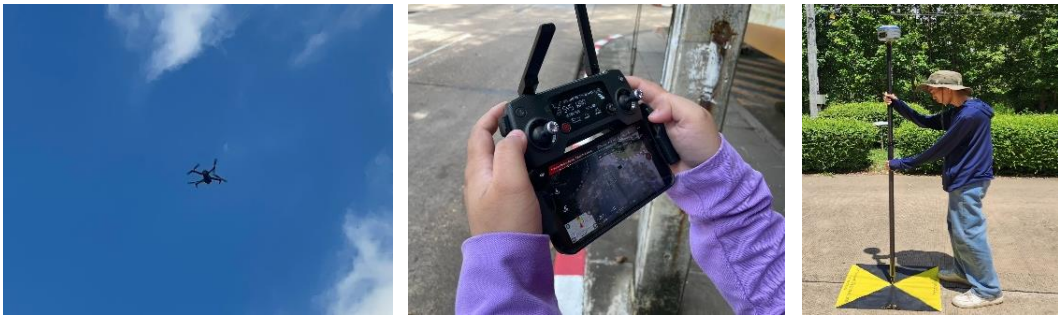
รูปที่ 4 การสำรวจด้วย UAV และ RTK
