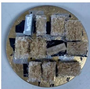
รูปที่ 5 การเตรียมตรวจสอบสัณฐานวิทยาของวัสดุเชิงประกอบพอลิเอทิลีนผสมเส้นใย
