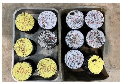
รูปที่ 4 ก้อนตัวอย่างทดสอบแอสฟัลต์คอนกรีตผสม RAP และเส้นลวดไผ่ใยรถยนต์
