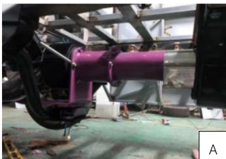
รูปที่ 3 การติดตั้งมอเตอร์ไฟฟ้าเข้ากับตัวรถ: ไม่ใช้เกียร์ (A) และ ใช้เกียร์ (B)
