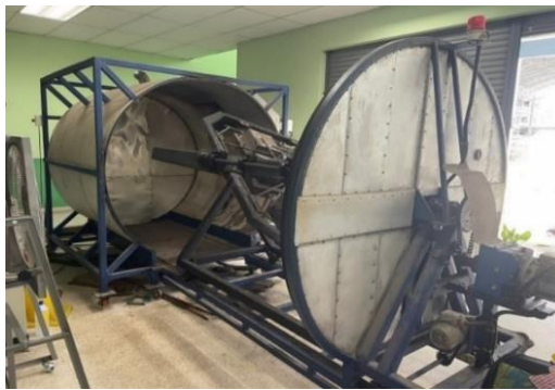
รูปที่ 2 เครื่องหมุนเหวี่ยง ยี่ห้อ BAIPAI รุ่น RMM2012
