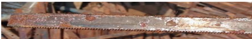
รูปที่ 3 ใบไม้มันสำปะหลังที่เกิดการสึกหรอ
