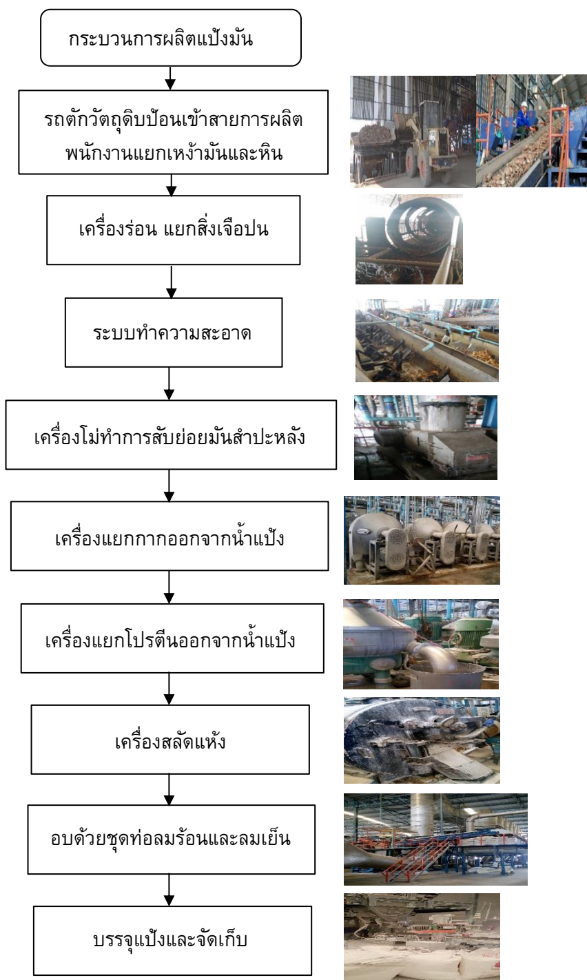
รูปที่ 2 แผนภูมิกระบวนการผลิตแยมมัน
