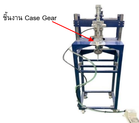
รูปที่ 8 เครื่องตอกก้อนอินเสิร์ตที่สร้างเสร็จ
