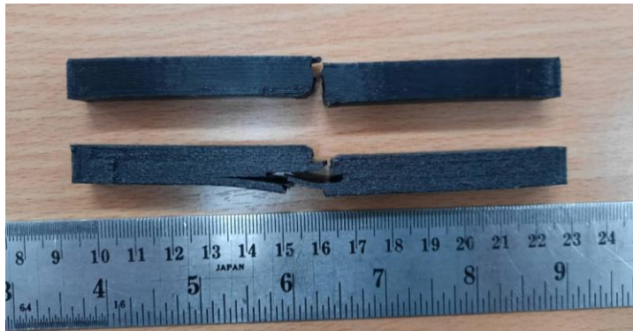
รูปที่ 15 เปรียบเทียบลักษณะการเสียหายของชิ้นงานทดสอบจากแรงกระแทก (ด้านบน) ชิ้นงานทดสอบที่ขึ้นรูปจากเส้นพลาสติกที่ถูกทิ้งไว้ในบรรยากาศห้องทดลอง 7 วัน (ด้านล่าง) ชิ้นงานทดสอบที่ขึ้นรูปจากเส้นพลาสติกที่ถูกทิ้งไว้ในบรรยากาศห้องทดลอง 35 วัน
