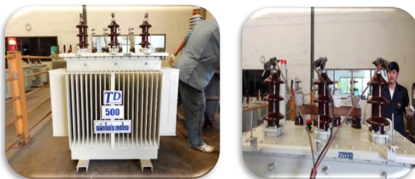
รูปที่ 3 ตัวอย่างการทดสอบหม้อแปลงในห้องปฏิบัติการทดสอบ
