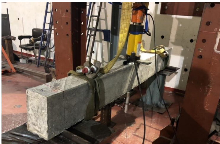
รูปที่ 3 การทดสอบตัวอย่างคานคอนกรีตเสริมเหล็กผสมเศษยางรถยนต์
