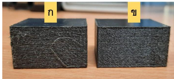
รูปที่ 2 เปรียบเทียบชิ้นงาน 3 มิติ ที่ขึ้นรูปจากเส้นพลาสติกที่มีความชื้นสูง (ก) ชิ้นงานที่ถูกขึ้นรูปจากเส้นพลาสติกที่มีความชื้นสูง (ข) ชิ้นงานที่ถูกขึ้นรูปจากเส้นพลาสติกที่มีความชื้นต่ำ
