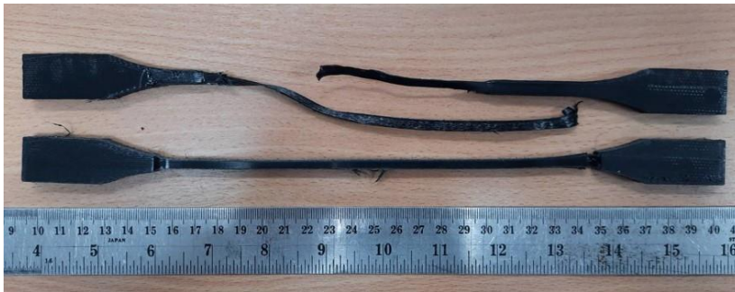
รูปที่ 11 เปรียบเทียบลักษณะการเสียหายของชิ้นงานทดสอบจากแรงดึง (ด้านบน) ชิ้นงานทดสอบที่ขึ้นรูปจากเส้นพลาสติกที่ถูกทิ้งไว้ในบรรยากาศห้องทดลอง 7 วัน (ด้านล่าง) ชิ้นงานทดสอบที่ขึ้นรูปจากเส้นพลาสติกที่ถูกทิ้งไว้ในบรรยากาศห้องทดลอง 35 วัน
