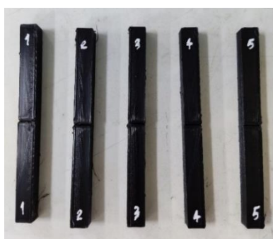
รูปที่ 10 ชิ้นงานทดสอบสำหรับการทดสอบความสามารถในการรับแรงกระแทก
