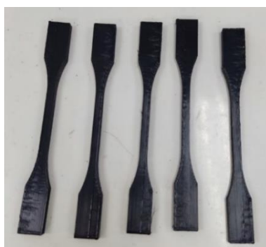
รูปที่ 9 ชิ้นงานทดสอบสำหรับการทดสอบความสามารถในการรับแรงดึง
