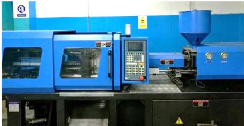
รูปที่ 2 เครื่องฉีดพลาสติก รุ่น HYF-1000
