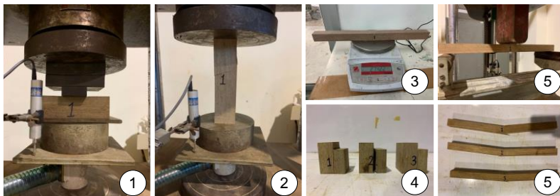
รูปที่ 5 การทดสอบคุณสมบัติเบื้องต้นของไม้ยางนาในห้องปฏิบัติการ
