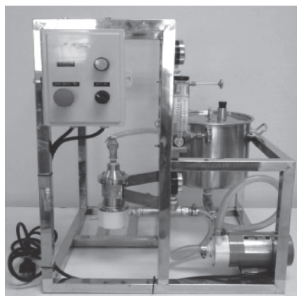
รูปที่ 4 ระบบฆ่าเชื้อจุลินทรีย์ในน้ำนมด้วยสนามไฟฟ้าแบบพัลส์ขนาดห้องปฏิบัติการ [3]
