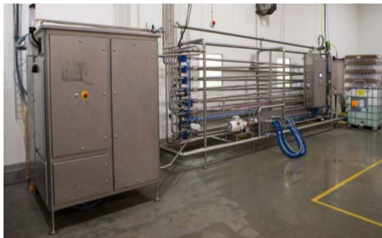
รูปที่ 6 ภาพถ่ายเครื่องพาสเจอร์ไรส์ด้วยเทคนิคพัลส์ระดับอุตสาหกรรมขนาด 1200 ลิตรต่อชั่วโมง [12]
