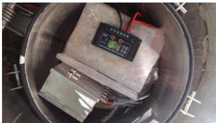
รูปที่ 10 อุปกรณ์อิเล็กทรอนิกส์ในภาชนะกันน้ำในบ่อไต้ดิน การติดตั้งอุปกรณ์สื่อสารที่สถานีทวนสัญญาณและศูนย์แจ้งเตือนข่าวสาร
