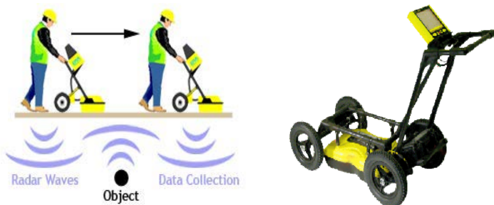
รูปที่ 1 เครื่อง Ground Penetrating Radar (GPR) [2, 3]
