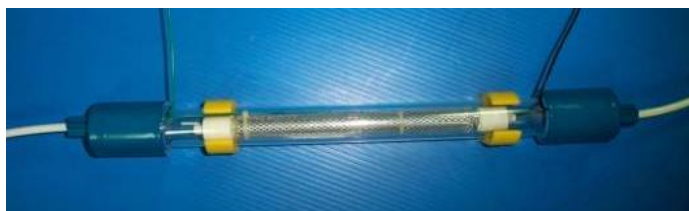
รูปที่ 3 อิเล็กโตรดผลิตโอโซนที่ออกแบบสร้างแล้วเสร็จ
