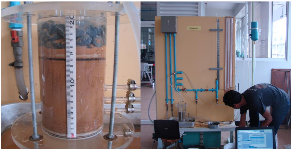
รูปที่ 4 เครื่องมือทดสอบการกักเซาะภายในโครงสร้างมวลดินที่พัฒนาขึ้นที่มหาวิทยาลัยเกษมบัณฑิต
