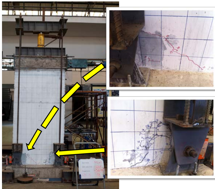
รูปที่ 14 รูปแบบการวิบัติของชิ้นทดสอบผนังคอนกรีตเสริมเหล็ก
