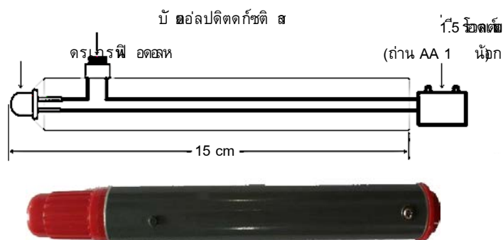
รูปที่ 4 โครงสร้างภายในและอุปกรณ์ที่ใช้ทำปากกาแสงอินฟราเรด
