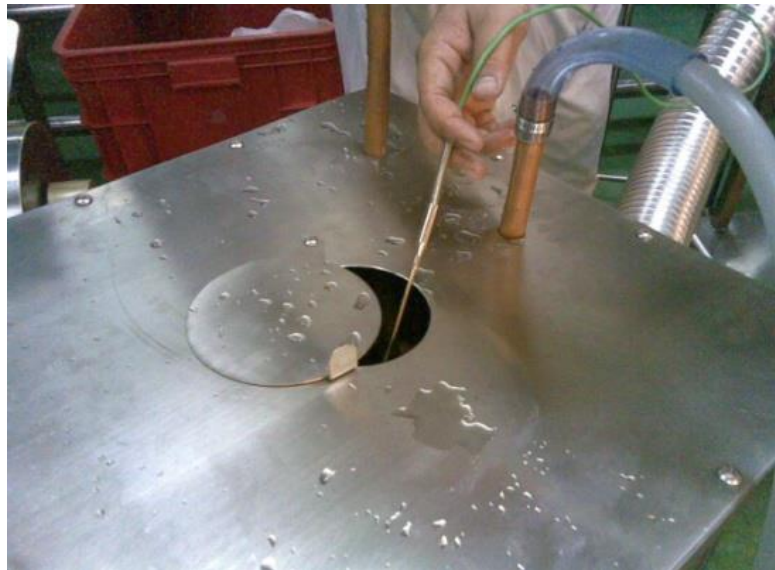
รูปที่ 8 วัดอุณหภูมิภายในกล่อง Heat Exchanger
