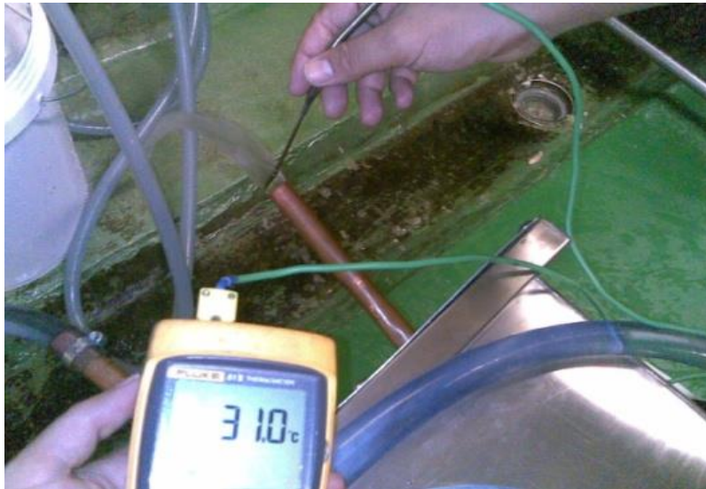
รูปที่ 6 วัดอุณหภูมิน้ำที่ได้ตามช่วงเวลา
