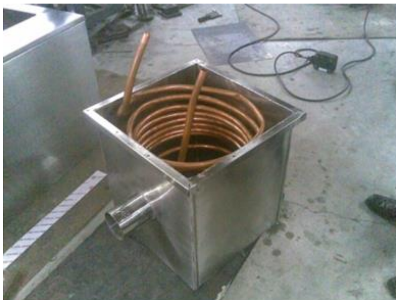
รูปที่ 4 กล่องแลกเปลี่ยนความร้อน
