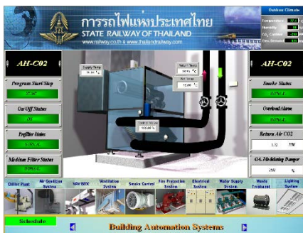
รูปที่ 5 การควบคุม AHU ผ่านระบบ BAS
