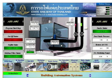
รูปที่ 5 การควบคุม AHU ผ่านระบบ BAS
