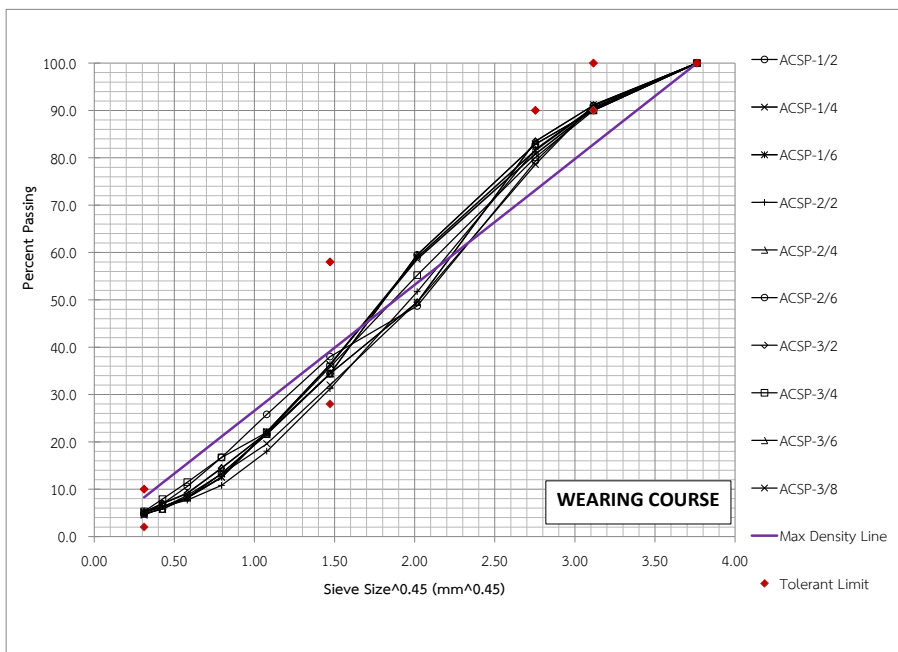
รูปที่ 2 ขนาดละเอียดของมวลรวมสำหรับชั้นผิวทาง (Wearing Course) NMAS 12.5 มิลลิเมตร
