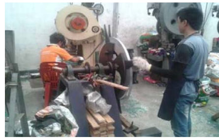
รูปที่ 9 การใช้คนในการหมุนคอยล์เข้าเครื่อง
