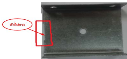
รูปที่ 10 ชิ้นงานเสียเนื่องจากตัดไม่ตรง
