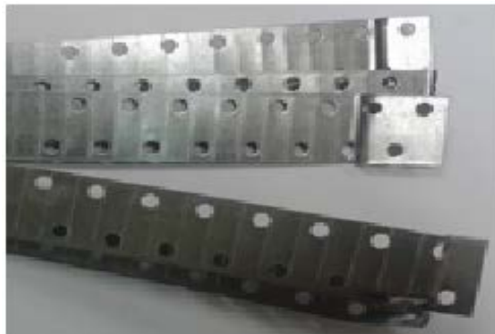
รูปที่ 13 ชิ้นงานเสียเนื่องจากบิดเสียรูป
