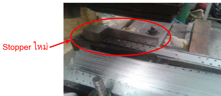
รูปที่ 15 Stopper ใหม่ที่ใหญ่ขึ้นและมีแนวกันด้านข้าง
