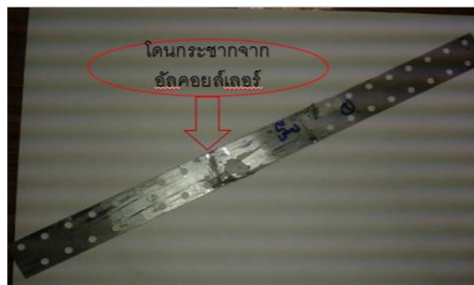
รูปที่ 6 ชิ้นงานเสียเนื่องจากอัลคอยล์เลอร์โดนกระชาก
