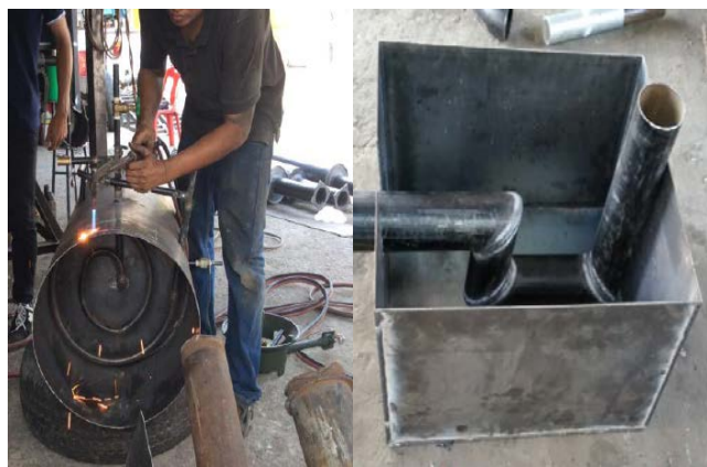
รูปที่ 6 การเชื่อมประกอบชุดท่อวงกลมและห้องอุ่นน้ำป้อนหม้อไอน้ำ
