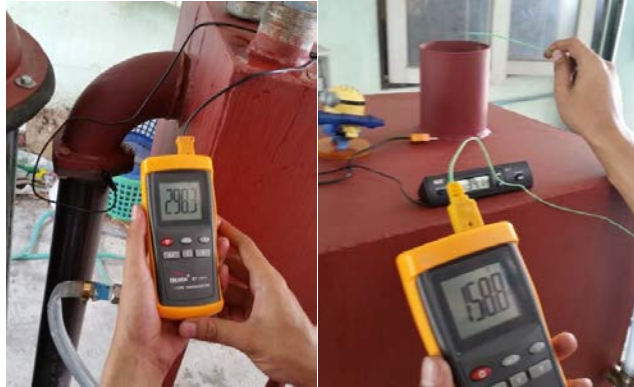
รูปที่ 8 ผลการตรวจสอบอุณหภูมิแก๊สไอเสียก่อนเข้าและหลังออกห้องอุ่นน้ำป้อน
