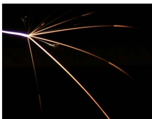
รูปที่ 9 การแตกตัวของประกายไฟแบบดาวและแบบสามกิ่งสองชั้นจากอิทธิพลคาร์บอน
