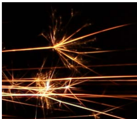
รูปที่ 13 การแตกตัวของประกายไฟแบบหลายกิ่งสามชั้นจากอิทธิพลคาร์บอน
