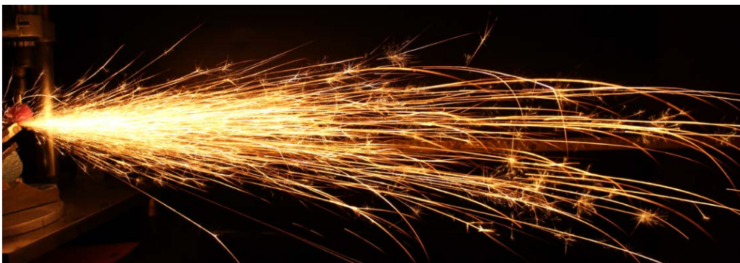
รูปที่ 11 ภาพถ่ายประกายไฟ JIS S45C จากการทดสอบ
