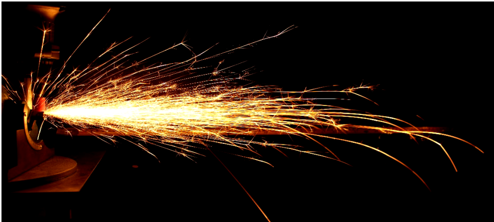
รูปที่ 5 การเจียรไนชิ้นทดสอบด้วยเครื่องทดสอบประกายไฟ
