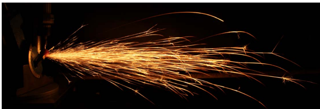
รูปที่ 7 ภาพถ่ายประกายไฟ JIS SS400 จากการทดสอบ
