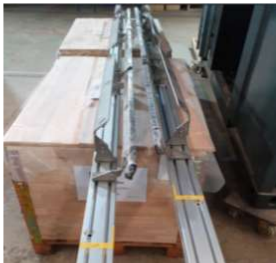
รูปที่ 10 การติดตั้ง Mirror & LED โดยจิ๊กเทมเพลตที่พัฒนาขึ้น
