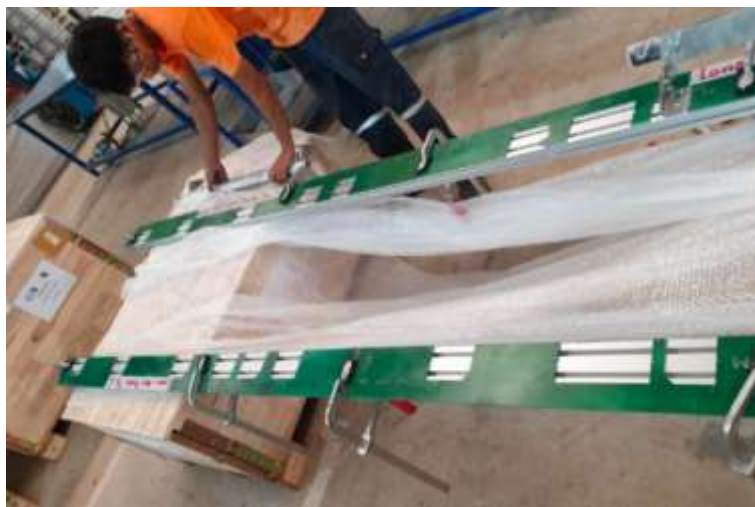
รูปที่ 8 จิกเทมเพลตหลังปรับปรุงที่ติดตั้ง Stopper แล้ว
