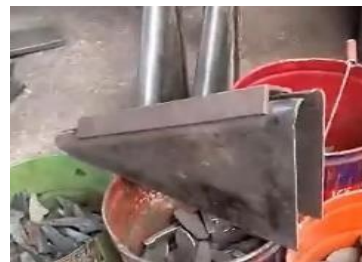
3) ใช้ Fixture lay out เพื่อตัดส่วนเกิน
