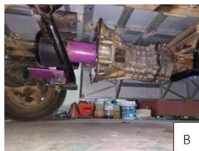
รูปที่ 3 การติดตั้งมอเตอร์ไฟฟ้าเข้ากับตัวรถ: ไม่ใช้เกียร์ (A) และ ใช้เกียร์ (B)
