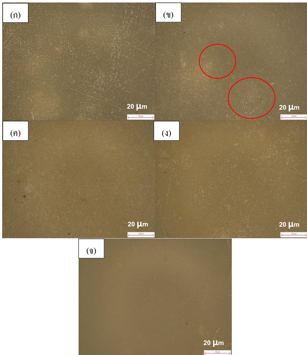
รูปที่ 6 ภาพถ่ายพื้นผิววัสดุเชิงประกอบยางธรรมชาติผสมผงนาโนไทเทเนียมไดออกไซด์ (ก) 0 phr, (ข) 1 phr, (ค) 2 phr, (ง) 3 phr และ (จ) 4 phr ที่ผ่านการฉายรังสียูวีเป็นเวลา 30 วัน กำลังขยาย 200 เท่า
