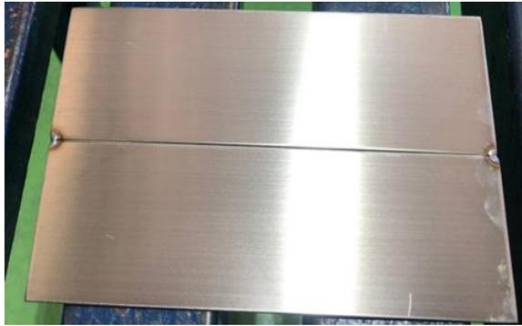
รูปที่ 2 รอยต่อของชิ้นงานหลังการเชื่อมยึด
