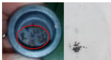
รูปที่ 14 ถั่วบอมบ์หลังการเผาไหม้พบวัสดุประสานคือแป้งมันสำปะหลังไม่เกิดการเผาไหม้
