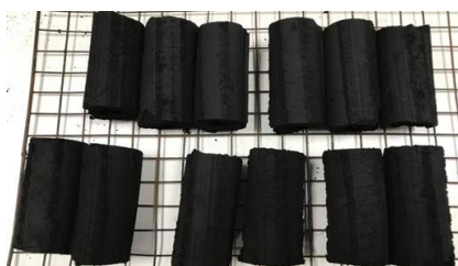
รูปที่ 9 ลักษณะถ่านจากเปลือกส้มโอผ่านการอัดที่ความชื้นร้อยละ 80
