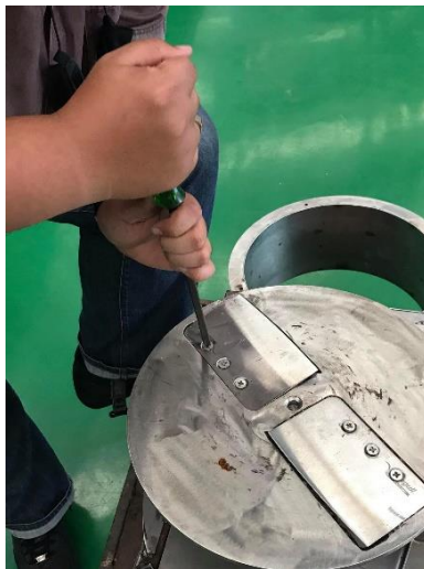
รูปที่ 7 ติดตั้งใบมีดเข้ากับจานใบมีด
