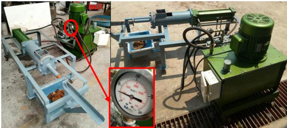
รูปที่ 2 เครื่องอัดแท่งชีวมวลความดันสูงแบบไม่ใช้ตัวประสานด้วยตัวระบบไฮดรอลิก
