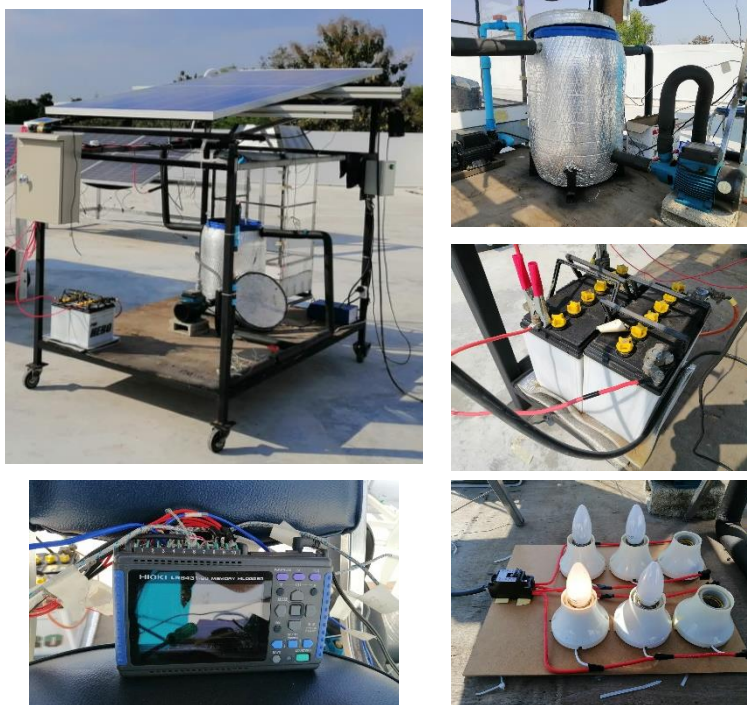
รูปที่ 5 อุปกรณ์และเครื่องมือที่ใช้ในการทดสอบประสิทธิภาพของแผงเซลล์แสงอาทิตย์ที่มีการติดตั้งท่อระบายความร้อน
