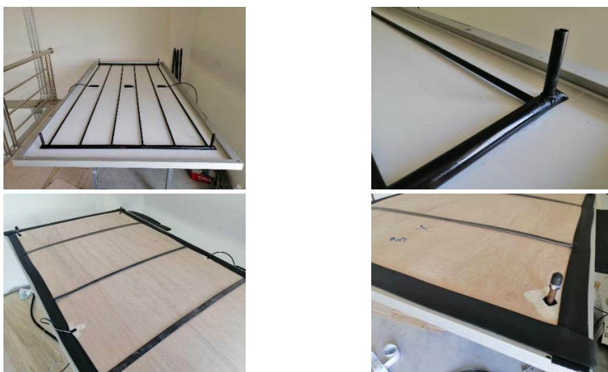
รูปที่ 3 ชุดระบายความร้อนใต้แผงเซลล์แสงอาทิตย์ (สร้างจริง)
