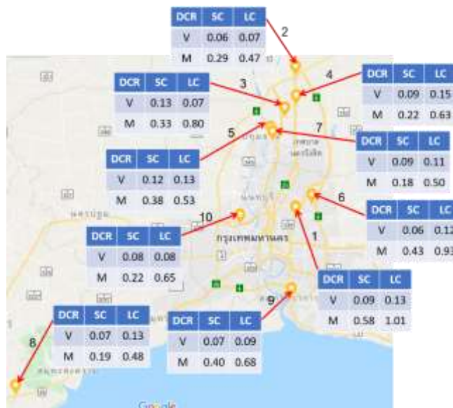
รูปที่ 8 ที่ตั้งและอัตราส่วนความต้องการต่อวิสัยสามารถ ( DCR ) ของแรงเฉือนและโมเมนต์ดัด เสาสะพานบริเวณกรุงเทพและปริมณฑล
