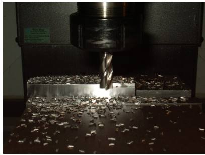
รูปที่ 2 การตัดเฉือนของโปรแกรม G41
