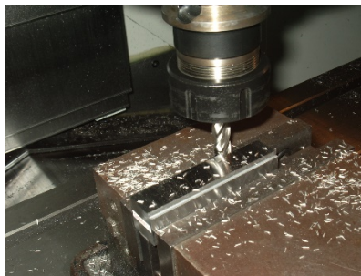
รูปที่ 3 การตัดเฉือนของโปรแกรม G42
