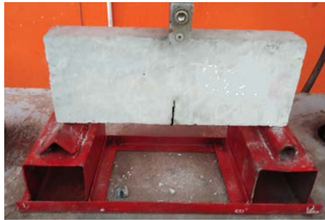
รูปที่ 11 คานตัวอย่างก่อนการทดสอบ
