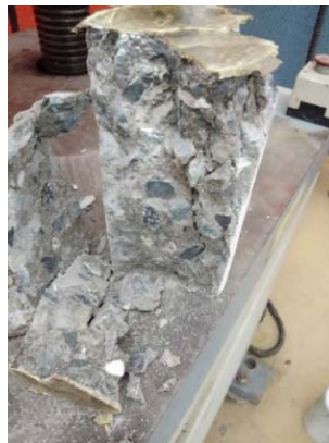
รูปที่ 7 การวิบัติของแท่งตัวอย่าง
