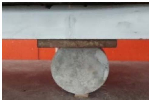
รูปที่ 5 การทดสอบ Brazilian Test
