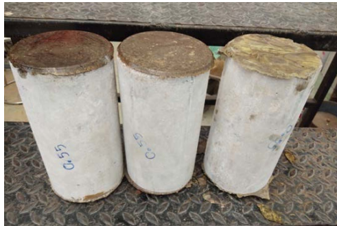
รูปที่ 4 ตัวอย่างที่เคลือบผิวแล้ว
