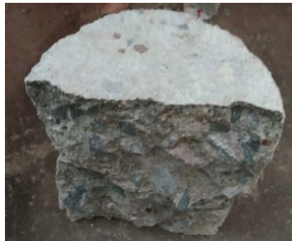
รูปที่ 9 การวิบัติแบบผ่าซีกของคอนกรีตรีไซเคิล
