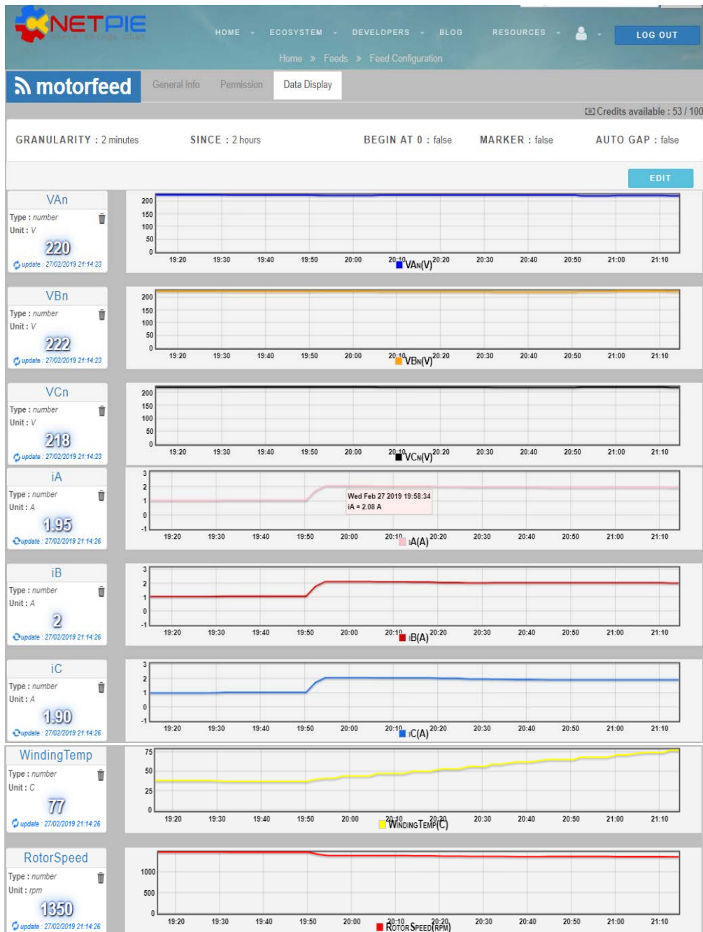
รูปที่ 28 การบันทึกค่าพารามิเตอร์ต่าง ๆ ของมอเตอร์ด้วย feed ของเน็ตพาย
