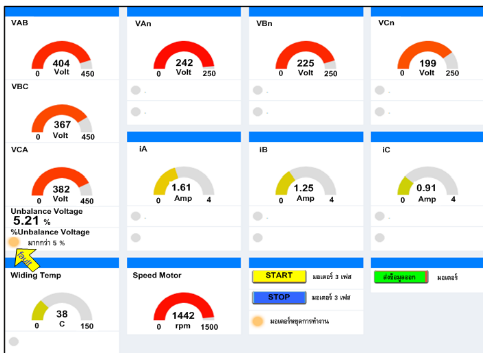
รูปที่ 23 สัญญาณต่าง ๆ เมื่อเกิด Unbalanced voltage fault ที่ \%V_{UB} = 5.21\%
