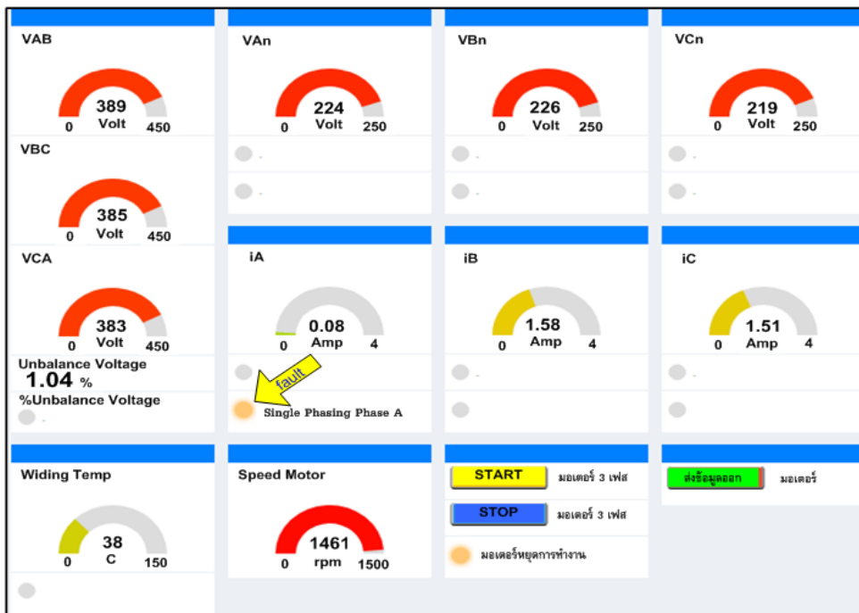
รูปที่ 22 สัญญาณต่าง ๆ เมื่อเกิด Single Phasing fault ของเฟส A
