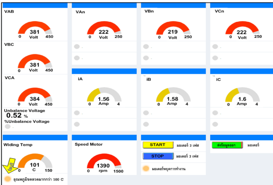
รูปที่ 27 สัญญาณต่าง ๆ เมื่อเกิด Over temperature fault
