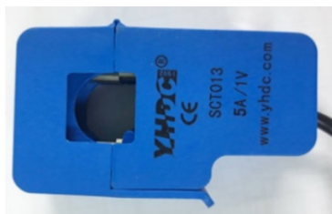
รูปที่ 5 หม้อแปลงกระแสที่ใช้เป็นตัวตรวจรู้
