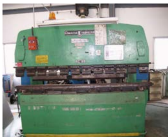
รูปที่ 1 เครื่องพับไฮดรอลิก (ซ้าย) และปัญหาาระบบตั้งระยะเสีย (ขวา)
