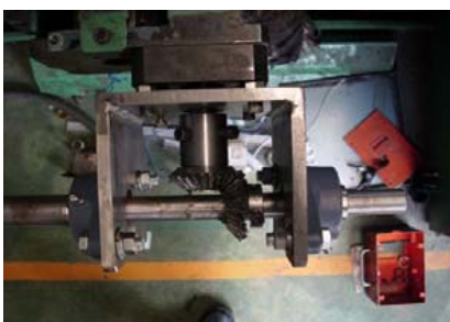
รูปที่ 13 ชุดควบคุมตัวปรับระยะท้ายเครื่อง
