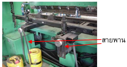
รูปที่ 1 เครื่องพับไฮดรอลิก (ซ้าย) และปัญหาาระบบตั้งระยะเสีย (ขวา)
