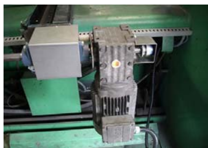
รูปที่ 13 ชุดควบคุมตัวปรับระยะท้ายเครื่อง
