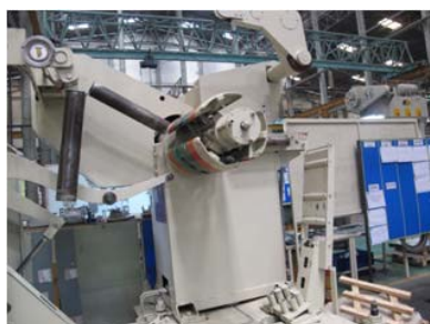
รูปที่ 20 การปรับปรุงระบบทางกลของเครื่องโดยติดตั้งชุดคลายม้วนเหล็กแผ่น
