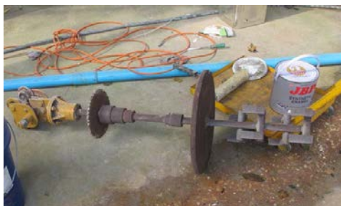
รูปที่ 21 การรื้อชิ้นส่วนเพื่อตรวจสอบสภาพการใช้งาน
