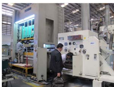
รูปที่ 20 การปรับปรุงระบบทางกลของเครื่องโดยติดตั้งชุดคลายม้วนเหล็กแผ่น
