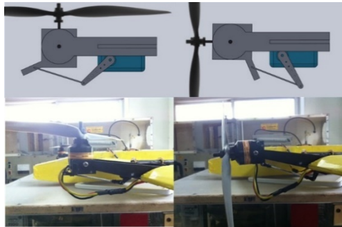
รูปที่ 7 การจัดสร้างกลไกการปรับมุมมอเตอร์คู่หน้า
