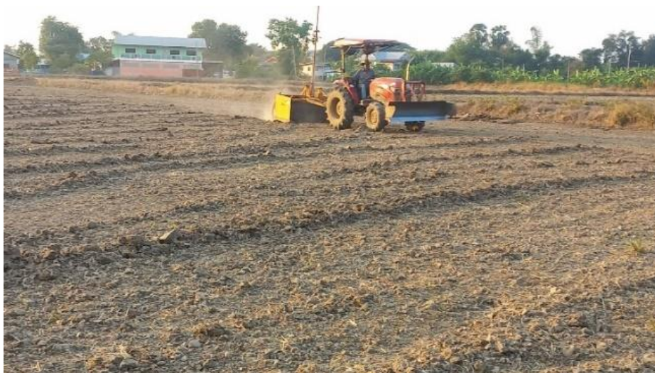
รูปที่ 3 การใช้เครื่องจักรกลปรับระดับดินนาด้วยแสงเลเซอร์
