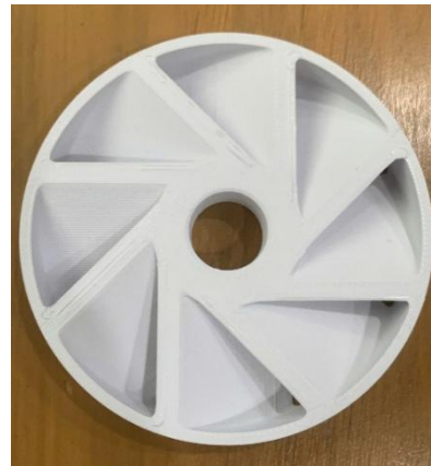
Fig. 3. The printed fan blade with 60°.
