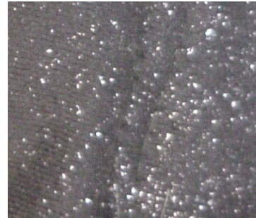
รูปที่ 14 เศษเหล็กจากการสึกหรอของพื้นเฟือง
