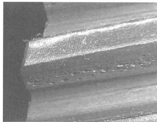
รูปที่ 12 เฟืองที่มีการสึกหรอแบบล้าตัว
