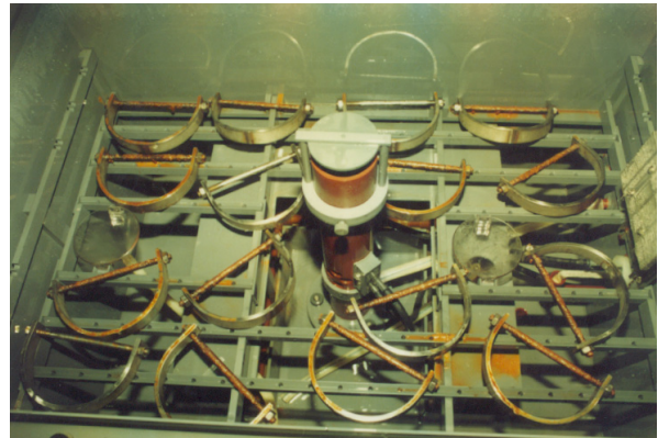
รูปที่ 12 ภายในตู้ทดสอบชิ้นงาน C-ring ในตู้ทดสอบในไอหมอกเกลือ NaCl (ขณะเปิดตู้ทดสอบ)
