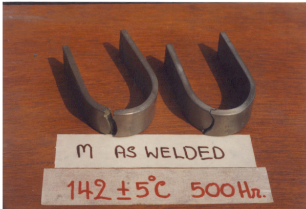
รูปที่ 8 สภาพขึ้นทดสอบเชื่อมด้วยกระบวนการ MIG ตัด U-Bend ให้เกิดความเค้น ต้มในสารละลาย MgCl_2 อิ่มตัว (42%) ที่ 142^\circ C ประมาณ 500 ชั่วโมง
