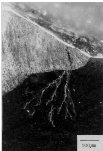
รูปที่ 6 ลักษณะรอยแตกร้าว SCC ที่เริ่มเกิดจากผิวรอยเชื่อมแล้วกัดกินลึกลงในวัสดุฐาน
