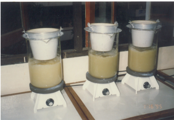
รูปที่ 11 การทดสอบต้มชิ้นงาน U-bend ในสารละลาย MgCl_2 ที่ 155 \pm 10^\circ C
