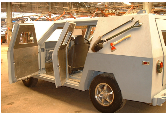
รูปที่ 22 ยานยนต์ต้นแบบที่ผลิตตัวถังเสร็จเรียบร้อยแล้ว
