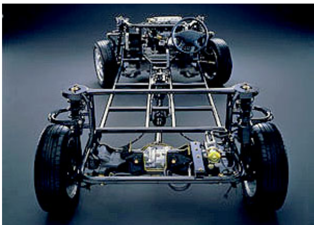
รูปที่ 7 ระบบช่วงล่างของการขับเคลื่อนระบบ 4 WD ของ Monocoque ซึ่งระบบการส่งกำลังเป็นไปอย่างอิสระทั้งสี่ล้อ ไม่มีข้อจำกัดเช่นเดียวกับระบบคานแข็ง
