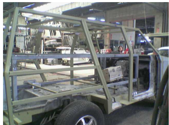
รูปที่ 21 สร้างโครงถักตามแบบที่ผ่านการวิเคราะห์
