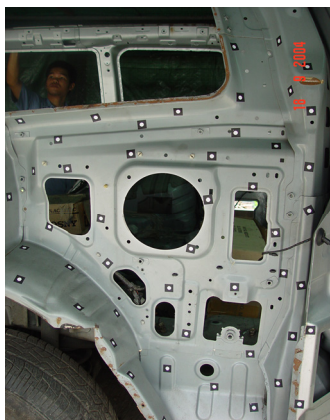
รูปที่ 11 เตรียมชิ้นงานเพื่อการสแกนจากยานยนต์ต้นแบบ
