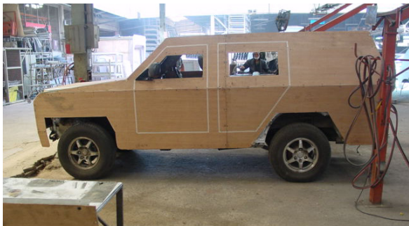
รูปที่ 20 ทดลองใช้ไม้อัดแทนแผ่นเหล็ก ครอบตัวถัง ยานยนต์ต้นแบบ
